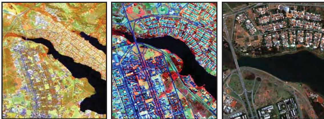
Fig. 1.18 Da esquerda para a direita, imagens dos satélites, Landsat com resolução espacial de 30m, Spot com 10 m e Ikonos com 1 m, de uma porção do lago Paranoá de Brasília.
