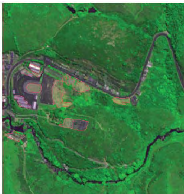
Fig. 13.4 Segmentação com limiar de similaridade = 50 e área (pixels) = 100.
