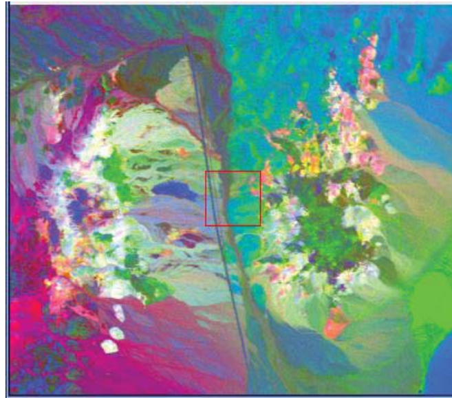
Fig. 14.12 Composição colorida com as três primeiras MNFs geradas de cinquenta bandas do AVARIS da região de Cuprite, estado de Nevada.
