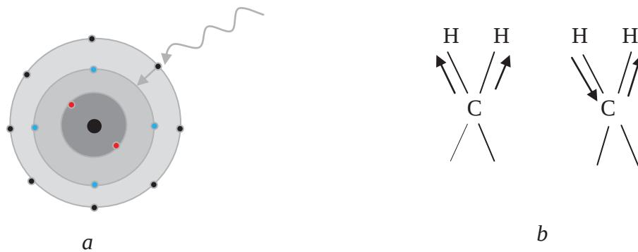
Fig. 1.4 A absorção da radiação eletromagnética pelos materiais desloca o elétron para um orbital de maior energia (a) ou aumenta a frequência dos movimentos vibracionais da molécula (b).
