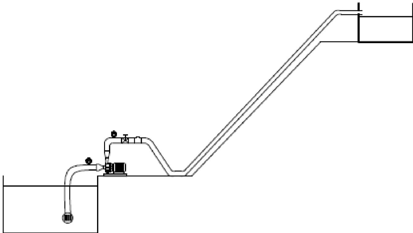
Calcular a potência absorvida pela bomba (B), recalcando 1000 L/min, se o vacuômetro (V) na sucção mostra um vácuo (pressão  $< P_{atm}$ ) de 300 mm Hg e o manômetro no recalque mostra uma pressão de 2,8 kgf.cm<sup>-2</sup>. Considere o rendimento da bomba de 60%.
