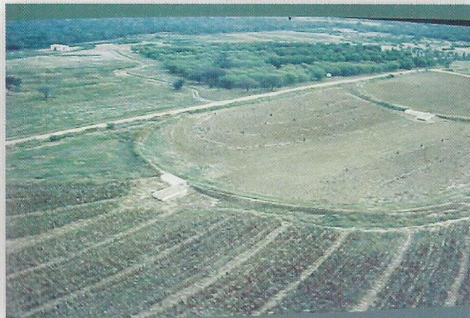
A barragem subterrânea possui a função de captar e armazenar água da chuva dentro do solo (subsolo).
