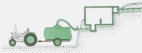
O fundo da chorumeira deve ter um rebaixo no piso, para facilitar a descarga. Também deve ser feita uma tampa de 60cm x 60cm, para permitir o emprego de mangotes de sucção dos tanques coletores ou a realização de vistorias.
