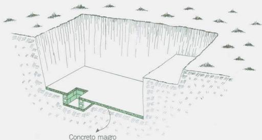
Uma maneira fácil e econômica de construir as paredes desse tipo de esterqueira é usar **blocos de concreto** de 20cm de largura, reforçados com pilaretes e cintas, na base e no topo, previamente definidos no projeto.
