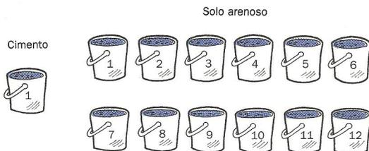
Esse traço padrão para pequenas obras será sempre o mesmo, qualquer que seja a forma de utilização do solo-cimento - tijolos ou blocos, parede maciça, pavimento ou ensacado.
