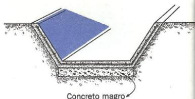
Os silos e reservatórios de ferrocimento, elevados ou enterrados, podem ser feitos em qualquer local, desde que apoiados sobre terreno firme, nivelado e bem compactado. Nesse caso não há necessidade de fundações. Basta fazer uma camada de concreto magro (traço recomendado na tabela da página 11 deste Fascículo 2), de 5 cm de altura, antes da colocação do aramado. Primeiro, a argamassa é aplicada nesse fundo, mas só pelo lado de cima. Depois, a argamassa é aplicada nas paredes.
