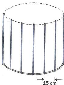
Já o espaçamento entre os vergalhões horizontais depende do diâmetro da base da peça e da sua altura. Uma vez escolhidas essas dimensões, veja no quadro abaixo o espaçamento a ser adotado
