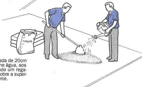
3. Espalhe a mistura numa camada de 20cm a 30cm de espessura, adicione água, aos poucos (de preferência usando um regador com "chuveiro" ou crivo), sobre a superfície, e misture tudo novamente.
