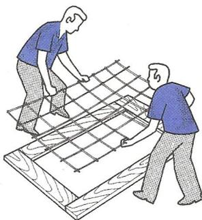
O conjunto de pilares, vigas e lajes é submetido ainda a outros esforços. Por isso, o cálculo estrutural determina também a colocação de uma armadura complementar, chamada de **ferro negativo**.
