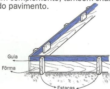
O comprimento e a largura da fôrma e da guia dependem das dimensões da área a ser pavimentada. Se ela tiver, por exemplo,  $9\text{m} \times 30\text{m}$ , o serviço deve ser executado em faixas de 3m de largura, e cada faixa em duas etapas de 15m. Nesse caso, a fôrma terá um contorno de 3m de largura por 15m de comprimento.
