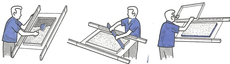
Na seqüência, a fôrma é erguida por duas pessoas. Cada uma segura de um lado, pelas travessas de madeira, mantendo a fôrma na posição horizontal. Finalmente, as duas travessas são aproximadas uma da outra, para que a fôrma fique curva. Quanto maior a aproximação, maior a curvatura.
