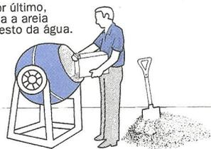
A betoneira precisa estar limpa (livre de pó, água suja, restos da última utilização) antes de ser usada. Os materiais devem ser colocados com a betoneira girando e no menor espaço de tempo possível. Após a colocação de todos os componentes do concreto, a betoneira ainda deve girar, no mínimo, por mais 3 minutos.
