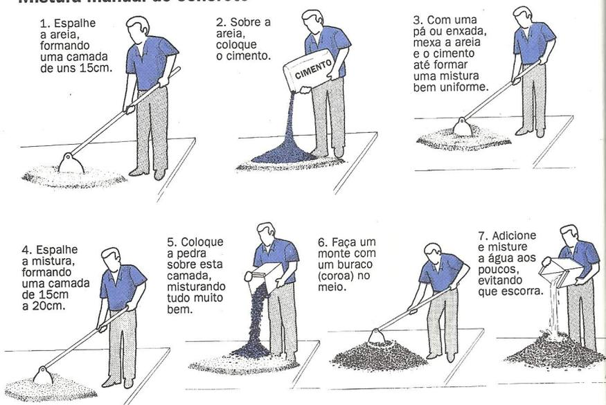
É muito importante que a quantidade de água da mistura esteja correta. Tanto o excesso como a falta são prejudiciais ao concreto. Se a mistura ficar com muita água, a resistência do concreto pode diminuir bastante, porque os componentes, em geral, se separam. Ao contrário, se a mistura ficar seca, ela será difícil de adensar. Além disso, a peça concretada ficará cheia de buracos, com aparência ruim e com baixa resistência.
