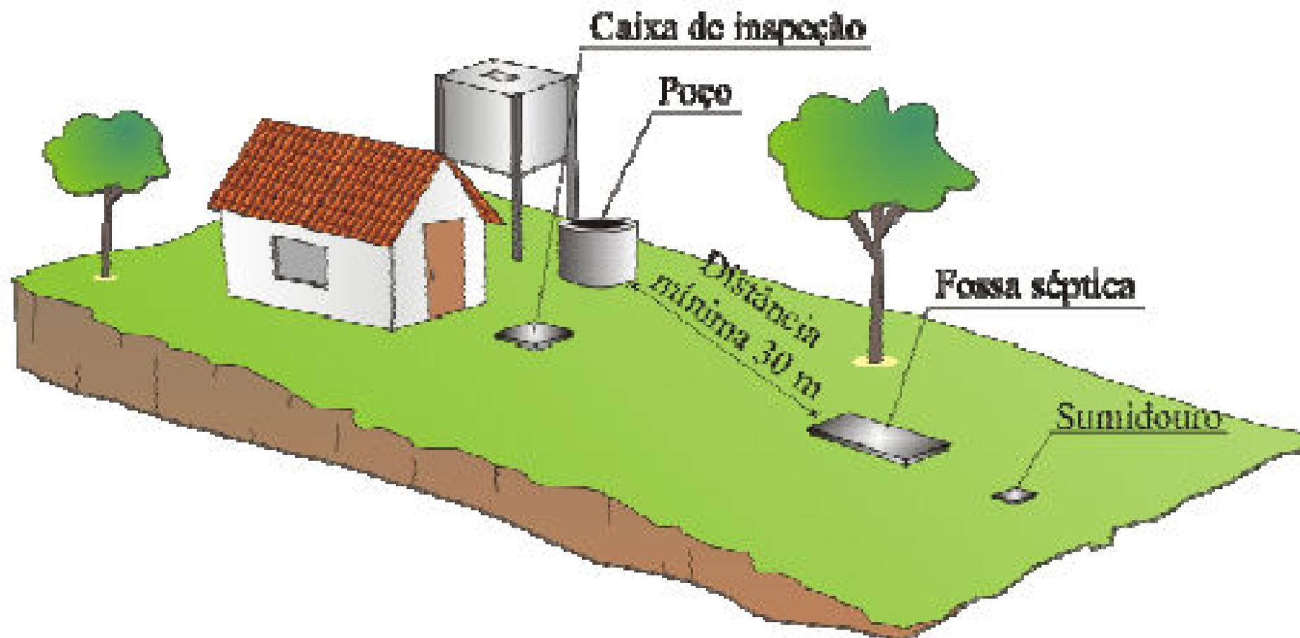
FIGURA 23 – Esquema do sistema de distribuição de esgoto domiciliar
