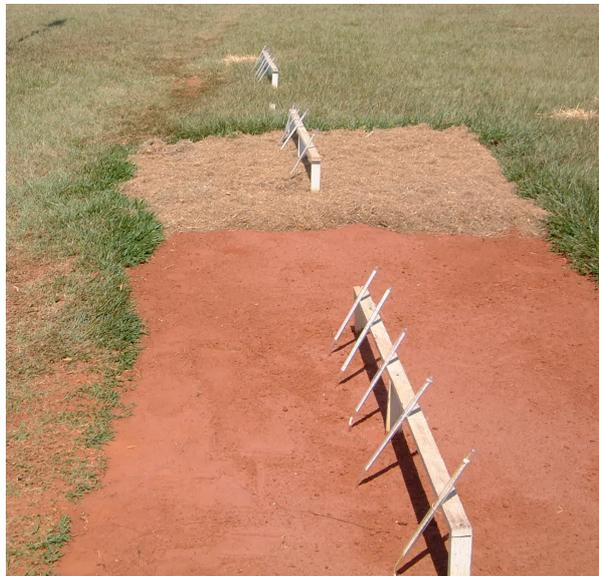
**Figura 1:** Bateria de geotermômetros.
