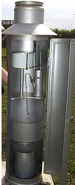
**Figura 17** – Pluviógrafo.
