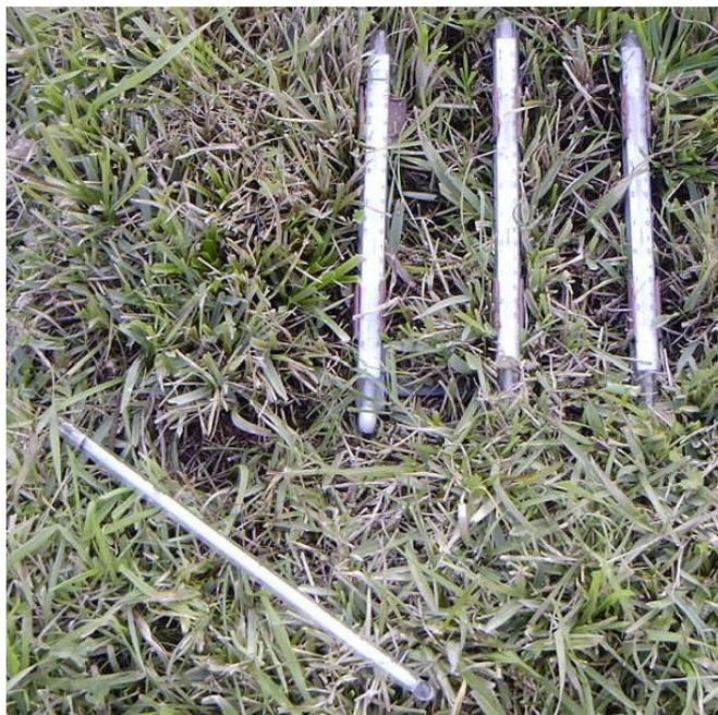
**Figura 7** – Termômetro de temperatura mínima de relva.
