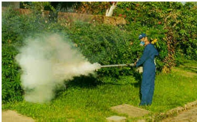
**Figura 4:** Aspecto do funcionamento de um termonebulizador.
