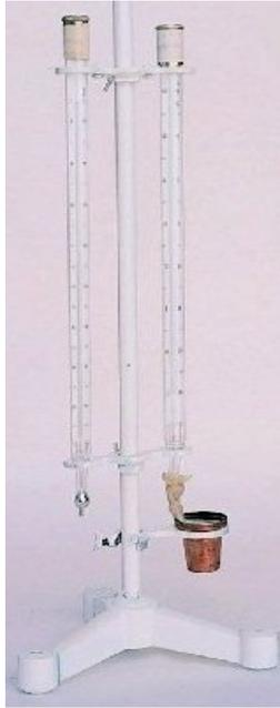
**Figura 2:** Psicrômetro não-aspirado.
