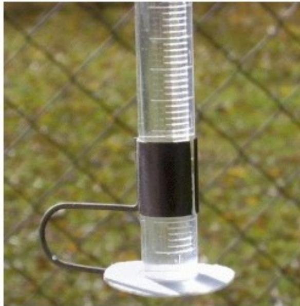
**Figura 9** – Evaporímetro de Pichê.
